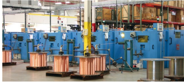
Fertigungshalle mit NIEHOFF-Doppelschlag-Verlitzmaschinen Typ D 631
